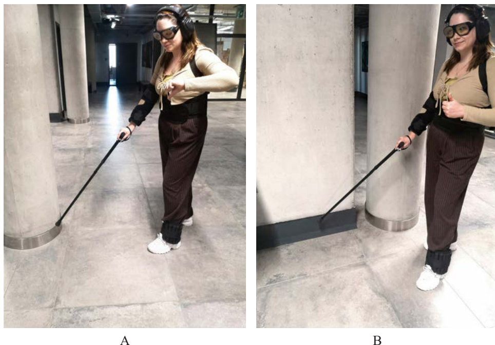
Rys. 6. Badanie rozwiązań materiałowych we wnętrzu: niewielki kontrast między materiałami płaszczyzny poziomej i pionowej stanowi barierę dla osoby niedowidzącej (A), wyraźny kontrast między materiałami płaszczyzny poziomej i pionowej stanowi wyraźną krawędź, co ułatwia orientację osobom niedowidzącym (B) [ze zbiorów autorki]
