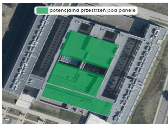
Rys. 7. Potencjalna przestrzeń do montażu paneli fotowoltaicznych
