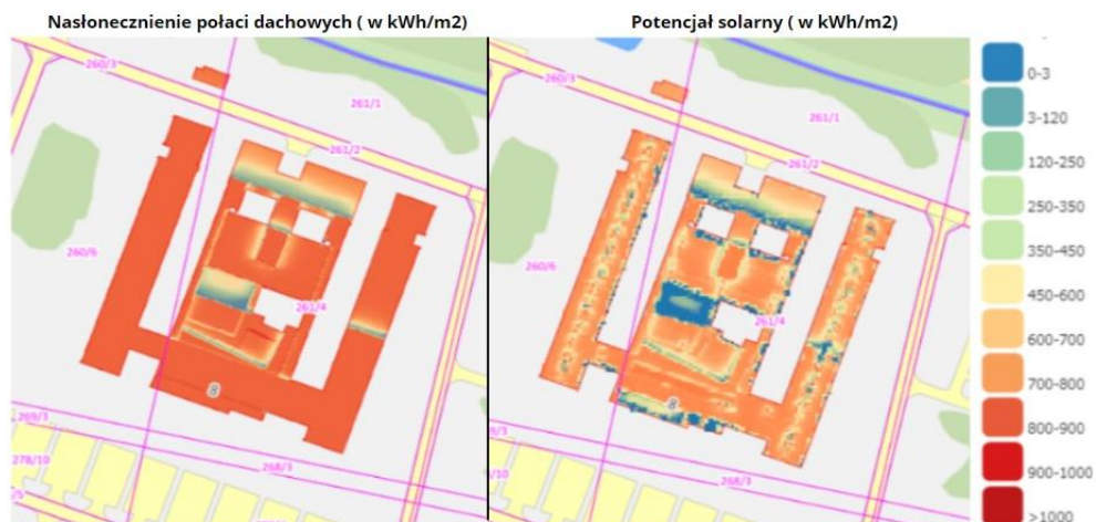
Rys. 4. Nasłonecznienie połaci dachowych i potencjał solarny (w kWh/m 2 ) Wydziału Chemii UAM [SIP Poznań 2024]
