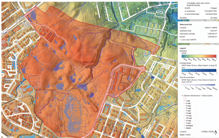
Rys. 3. Widok ogólny na MPZP 1917 wygenerowany w SCALGO Live z opadem 25 mm w formie naturalnej bez ingerencji (NMT + Flash Flood Mapping (Flooded Areas oraz Flow Accumulation) – analiza sływu powierzchniowego)
