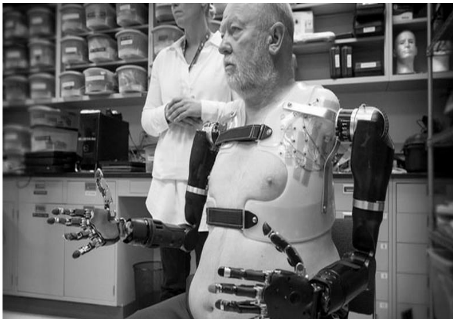
Rys. 2. Protezy ramion sterowane myślą . Wynalazek został opracowany przez naukowców z Laboratorium Fizyki Stosowanej znajdującym się przy Uniwersytecie Johnsa Hopkinsa w Kolorado. Sformułowanie sterowanie myślą jest oczywiście dużym uproszczeniem. Opisany system opiera się na elektromiografii powierzchniowej (SEGM), czyli pomiarze sygnału elektrycznego związanego z aktywacją mięśni, który następuje na skutek ich skurczu (Smoleńska 2014).
