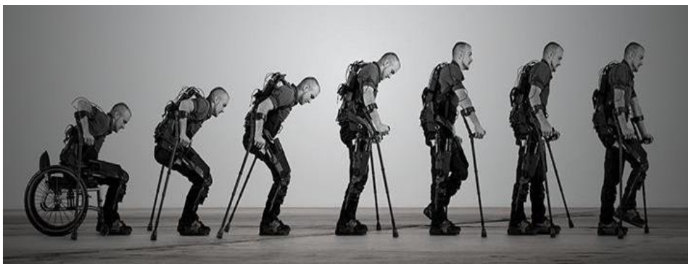
Rys. 1. Egzoszkielet usprawniający rehabilitację i umożliwiający samodzielne poruszanie się osobom niepełnosprawnym (Stradowski 2012)
