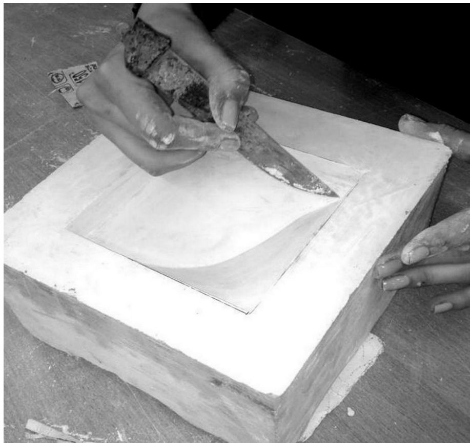
Ryc. 7. Gipsowa forma negatywowa poddawana niewielkiemu retuszowi (część wewnętrzna)
