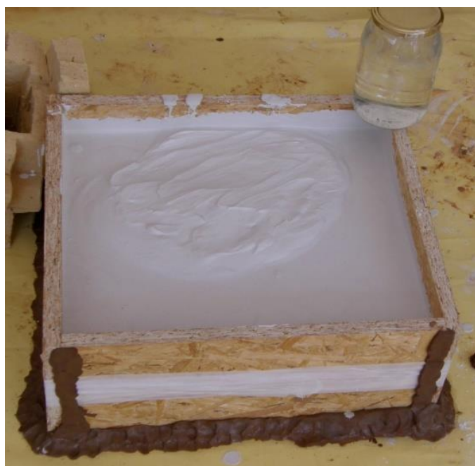
Ryc. 6. Prototyp modułu zalany gipsem ceramicznym – forma negatywowa (część zewnętrzna)
