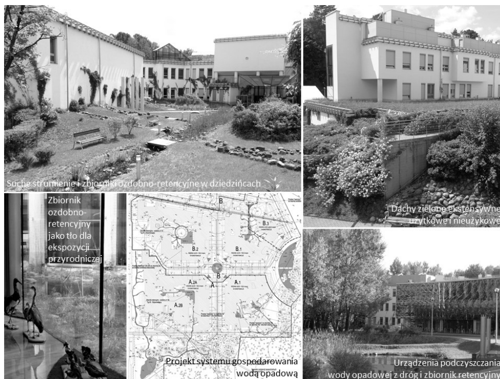
Rys. 7. System lokalnego gospodarowania wodą opadową w Kampusie Uniwersytetu w Białymstoku [z archiwum projektantów [fot. K. Ilmurzyńska]
