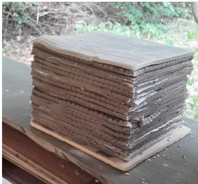
Rys. 5. Suszenie płytek przed wypałem na biskwit [zdjęcie K. Grygorowicz-Kosakowska]
