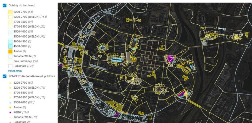
Rys. 3. Poznań. Plan głównych temperatur barwowych dla iluminacji wybranych obiektów w Poznaniu. Opracowanie zespół STUDIO DL [Ciupak et al. 2022]
